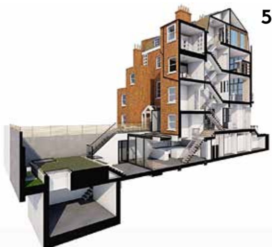
5. Τρισδιάστατη τομή στο ArchiCAD. Πηγή: Applecore Designs.
